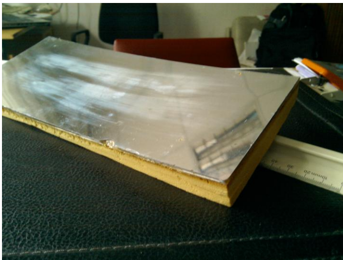
Рис.7.3. Фрагмент сферического зеркала на основе пенополиуретана для детектора ГИРЕРОН в ИФВЭ
